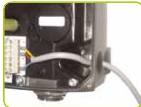
2.8. Протянуть провода через монтажные отверстия.
