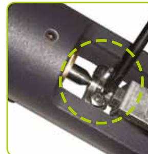
2.4. **ОБЯЗАТЕЛЬНО** закрепить привод на клапане с помощью фиксирующих винтов под шестигранник.
