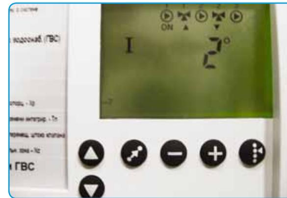
**ОГРАНИЧЕНИЕ ТЕМПЕРАТУРЫ ВОЗВРАЩАЕМОГО ТЕПЛОНОСИТЕЛЯ**
