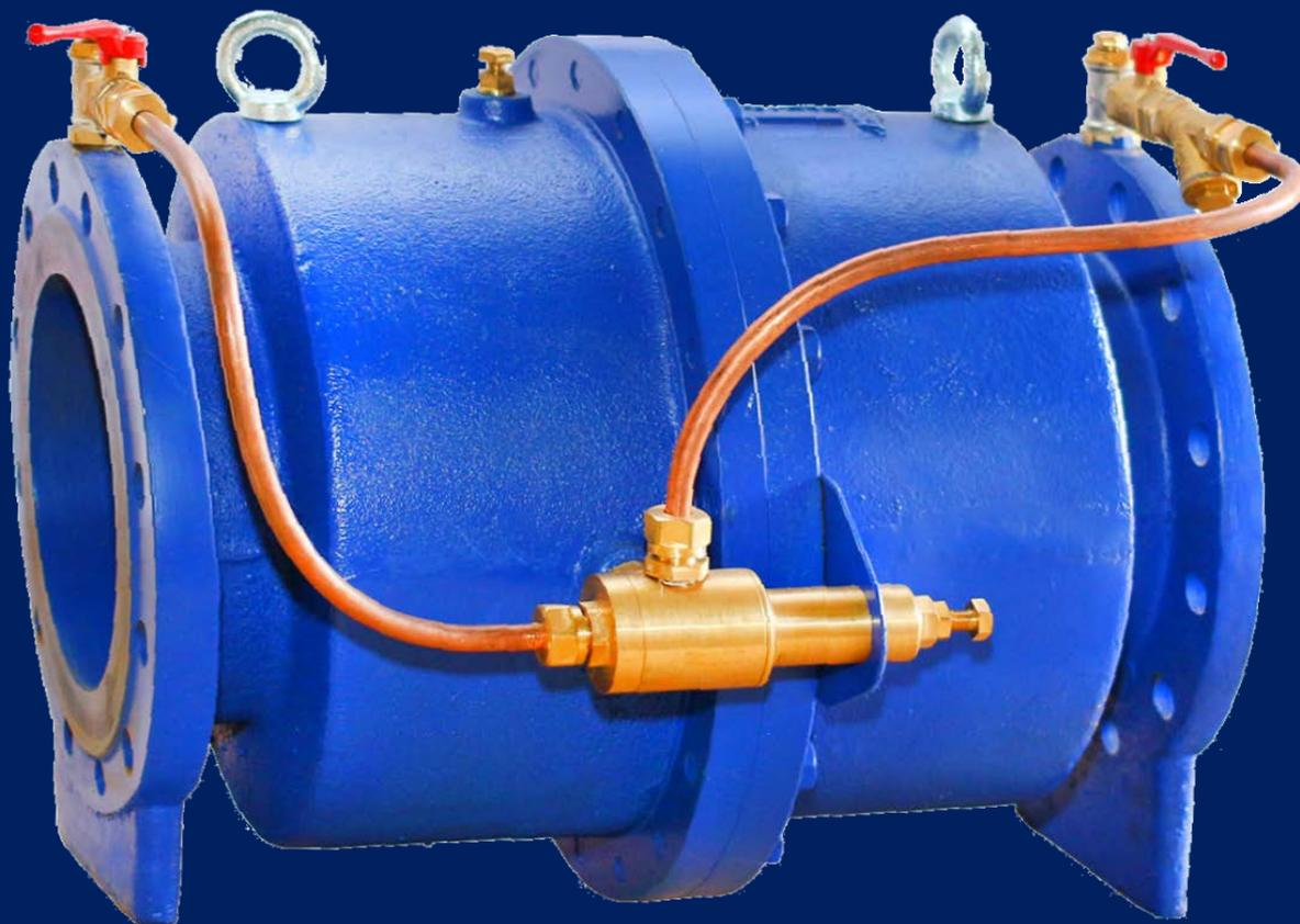
Регулятор давления состоит из корпуса с входной и выходной полостями, камеры управления, основного и «пилотного» клапана (управляющего устройства). Корпус клапана изготавливается из стали или высокопрочного чугуна, устойчивого к большим механическим и гидравлическим нагрузкам, седло клапана и посадочные места изготавливаются из нержавеющей стали, «пилотный» клапан имеет латунную конструкцию.
