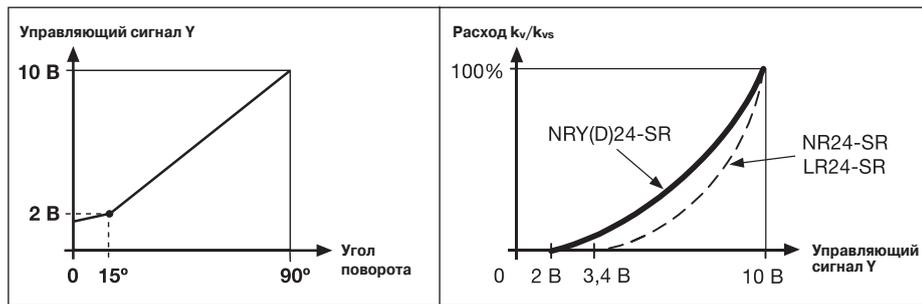
Электропривод позиционируется в положении 15° при значении управляющего сигнала приблизительно 1,9 В (рабочий диапазон 2...10 В). Электропривод открывает клапан по линейной зависимости от 15 до 90° между 2 и 10 В.
