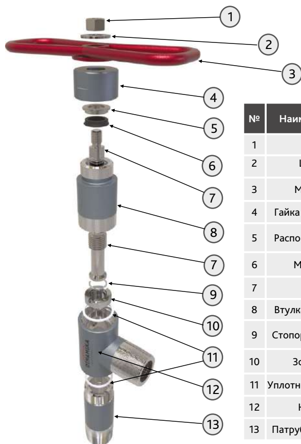
ВУС-50-(14,16,21)-М1 деталировка и материалы
