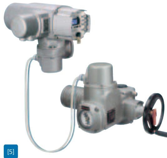
[5] Многооборотные приводы со средствами управления на настенном креплении Средства управления могут быть смонтированы на настенное крепление отдельно от привода. Это рекомендуется в случае если: ■ Невозможно смонтировать средства управления непосредственно на привод из-за ограниченности пространства, ■ Высокая температура окружающей среды способна повредить электронные элементы привода, ■ Интенсивная вибрация клапана может оказать влияние на средства управления.
